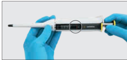
①ロックボタンを上へスライドして解除。 ロック解除中は赤い印が確認できます。
