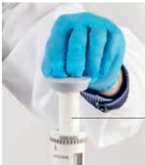
セラミックピストン 高い耐薬品性のパーツを使用
