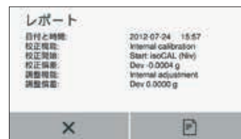
Cal Audit Trail 機能 (校正/調整監査証跡) で常時校正/調整データを保存
