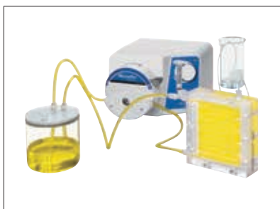
左:ダイアフィльтраーションリザーバー 中央:ペリスタポンプ 右:ビバフロー-200
