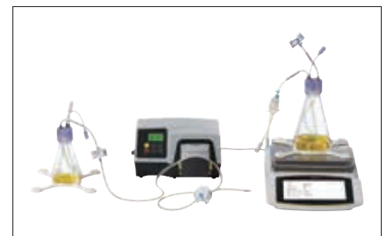
制御可能なペリスタルティックポンプと連動した 充填アプリケーションも使用可能
