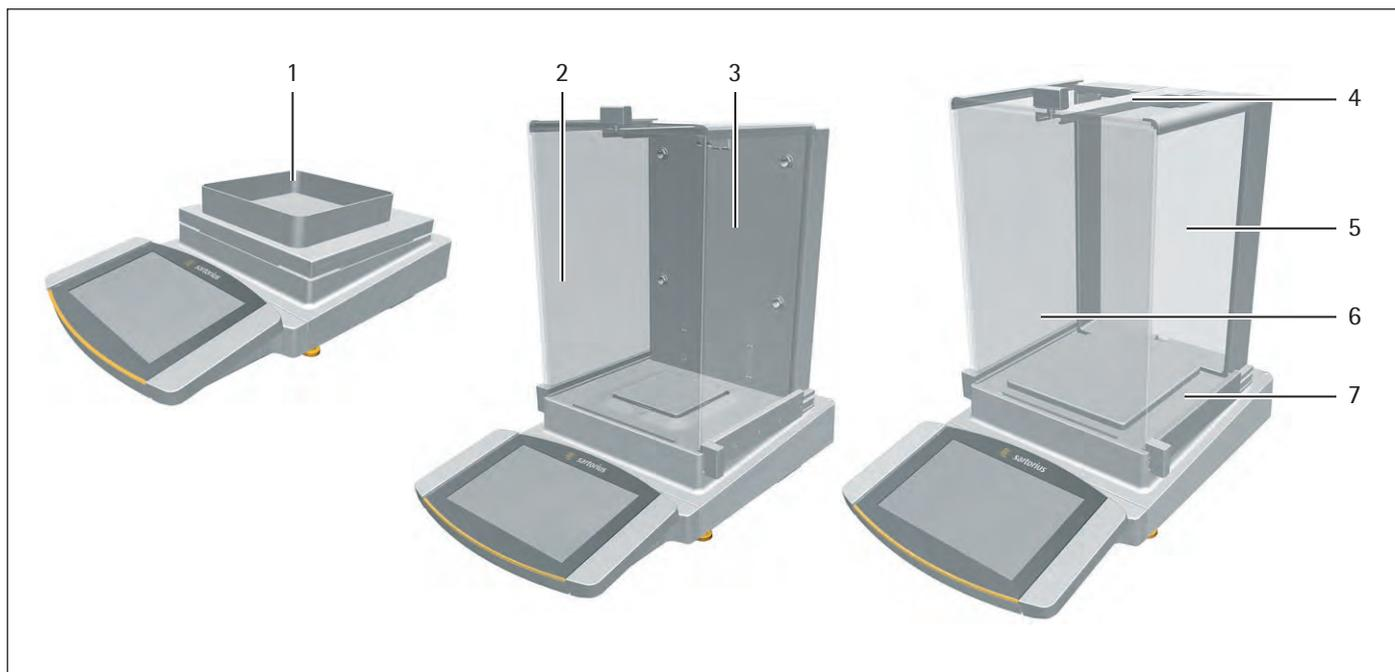
図2: フレーム風防付き精密天びん、電動分析風防付き分析天びん、手動分析風防付き精密天びん (例)
