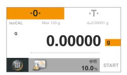
▶ パーセント(%ひょう量)アプリケーションが表示されます。 参照パーセントが参照に表示されます(例:10.0%)。
