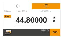
▶ 測定された最大ひょう量値が表示され、サンプルを天びんに載せている 限り維持されます。
