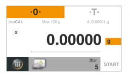
▶ 平均化(動物ひょう量) アプリケーションが表示されます。 設定されている測定回数が測定に表示されます。
