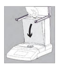
必要に応じて、清掃のために風防内背面パネルを取り外します。
