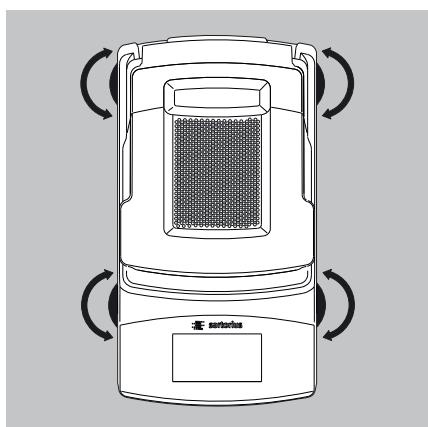
▶ レベリングフットをひねり、設置面が平らになるよう調整して、水分計を安定させます。
