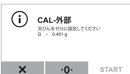
▷ 校正用分銅(100g)を載せるよう促すメッセージがディスプレイに表示されます。
