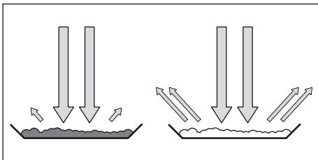
サンプルを加熱しない赤外線は、サンプルの表面で反射されるか、またはそのままサンプルに浸透します。
