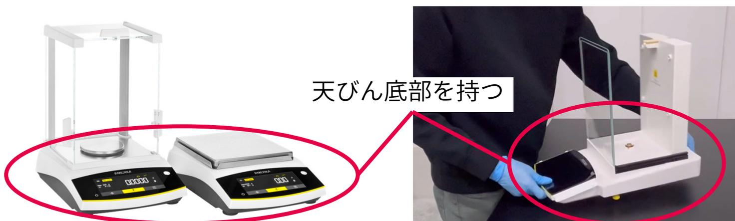
※ひょう量皿は絶対に押し込まないでください。破損しますので、そっと置いてください。
