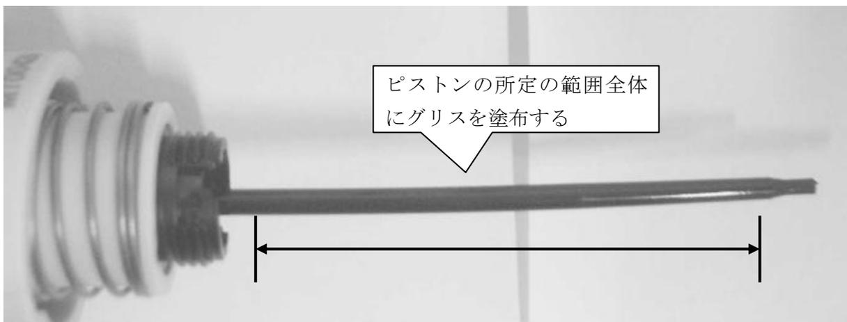
B) Pipettor m200, m1000
