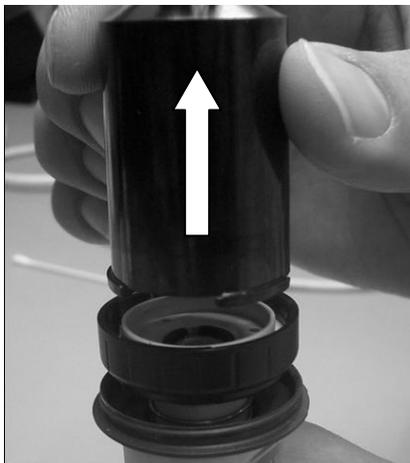
注) ピストンも反時計回りに回すと外れますが、通常のメンテナンス時は外さないで本体に取り付けたままでメンテナンスされることをお勧めします。メンテナンス時は、必ずしもピストンの取り外しが必要というわけではありません。
