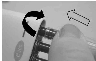
4.3 チップエジェクターバーを取り付けます。チップコーンロックングピースを押し込み、チップエジェクターバーを押し込みます。
