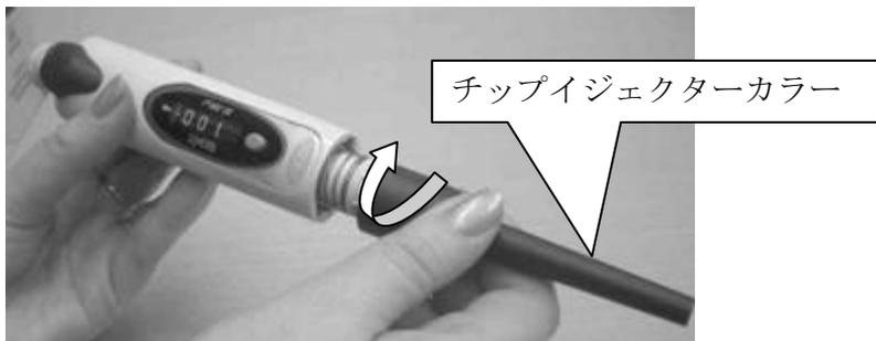
注) m5000, m10mLのチップエジェクターカラーは太いため力が入りやすいので、締め過ぎによる破損にご注意ください。
