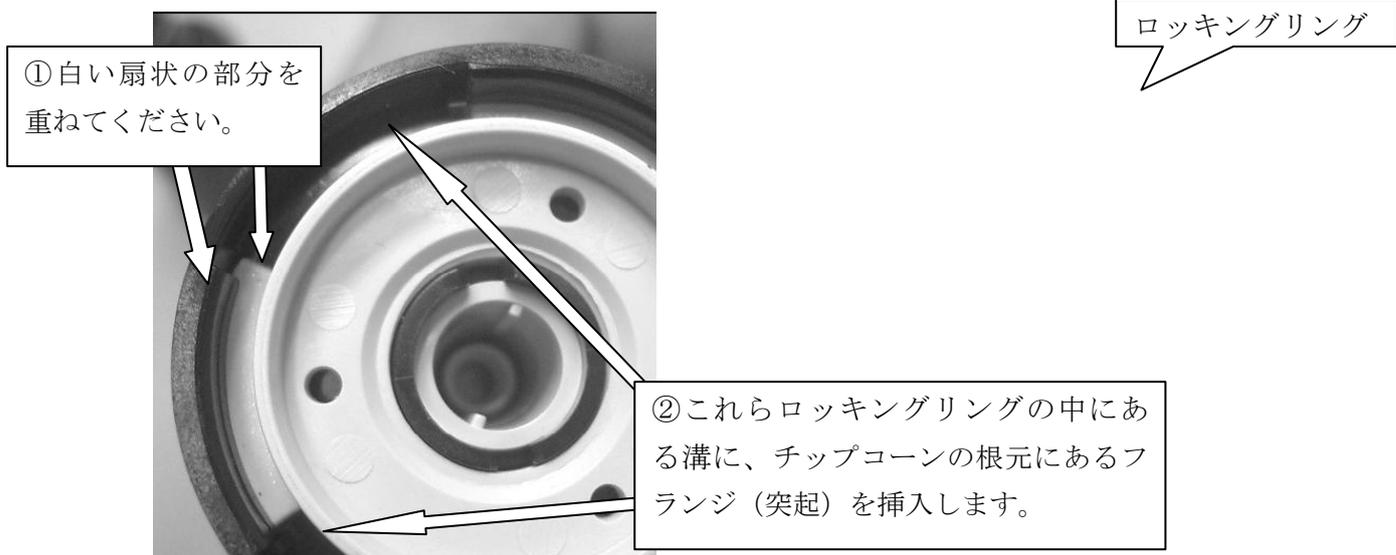
チップコーンがロックリング内部の根元までしっかりと差し込めたら、チップコーンが上向きになるように本体を握り、ロックリングを反時計回りに回転させてチップコーンをロックします。
