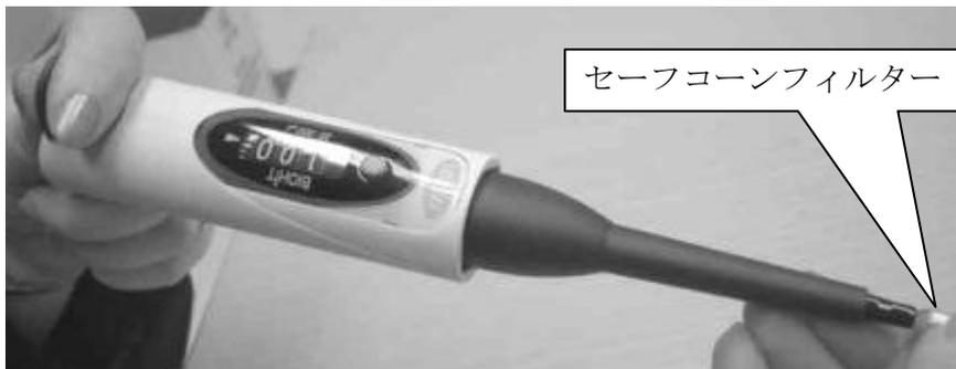
オペレーティングボタンを10~20回連続作動させて、ピストン内のシリコングリスをさらに均一にさせます。
