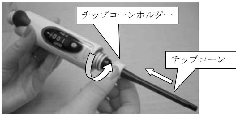
注) Pipettor m3, m10は、チップコーンの上部と下部が緩んでしまっていないか確認してください。緩んでいた場合は下部を時計回りで締めてください。
