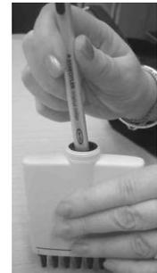
4.2 ピストンをチップコーンに挿入し（約 2cm ほど引き出しておいてください。）、チップコーンハウジングに差し込みます。チップを取り付け、チップコーンを押し込み、時計回りに回して固定します。全てのピストンチップコーンを取り付けます。
