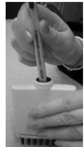
3.4 チップエジェクターロックングピースを図のように押し、チップエジェクターバーを取り外します。
