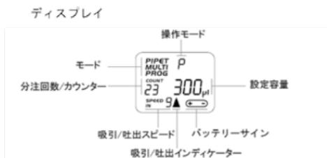
(注) ピペット・ディスプレイは 10 分間使用しないとバッテリーの消耗を防ぐため自動的にパワーオフになります。再起動は、いずれかのキーを押して下さい。
