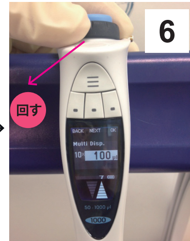
分注容量設定：容量のところが反転していると容量を変更可能です。
