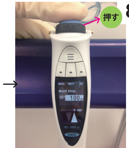
分注容量設定の後、プッシュボタンを押して確定します。
