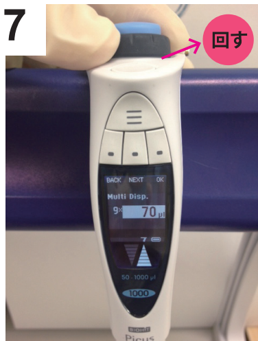
分注容量設定：左にダイヤルを回すと、容量が小さくなります。戻すときは右に。
