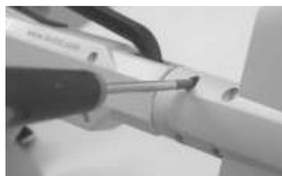
C) チップコーンハウジングの上部カバーを取り外します。
