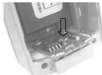
F) 新しいバッテリーのプラス側を本体内部のスプリング側 (+) に押し付けた後、滑り込ませるようにして装着します。
