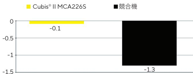
図8：Cubis®II MCA226S と他社製天びんの気圧変化テスト結果。
