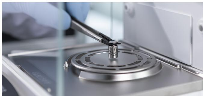
図1：Cubis® II ウルトラハイレゾリューションセミマイクロ天びんで、USP チャプター41に準拠した最小計量値を測定
