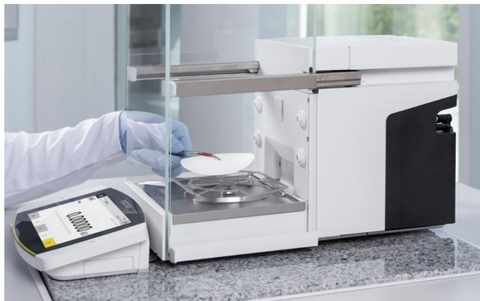
図6：Cubis®II ウルトラ ハイレゾリューション天びんに内蔵されたイオナイザーにより、帯電したサンプルであっても問題なくひょう量できます。
