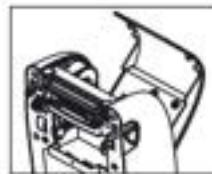
3. リボンの右側を供給ハブに挿入します。切り込みを左側に合わせ、リボンをスプークに取り付けます。
